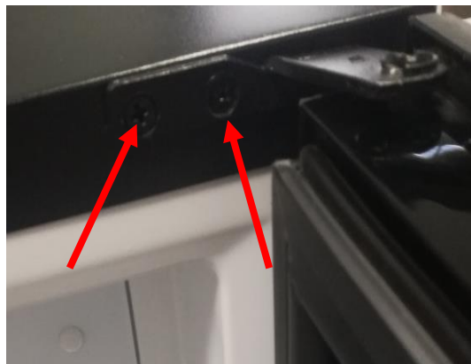
Enlever les deux vis qui fixent la charnière supérieure
