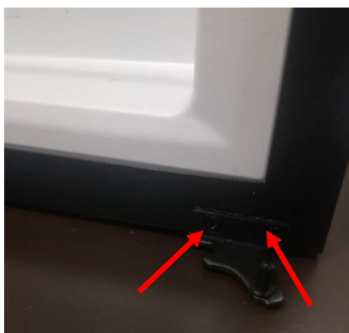
Die zwei Schrauben, die den rechten Fuß festhalten, abschrauben
