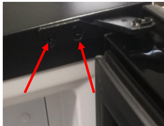
Die zwei Schrauben, die das Gelenk festhalten, abschrauben
