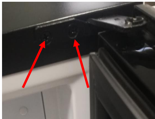
Svitare le due viti che fissano la cerniera
